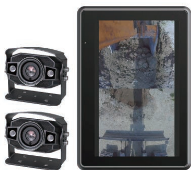
アーム・ブームの2つのカメラで、バケット先端とブーム真下をリアルタイムに確認。
