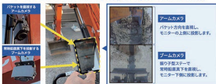
アーム・ブームの2つのカメラで、バケット先端とブーム真下をリアルタイムに確認。
